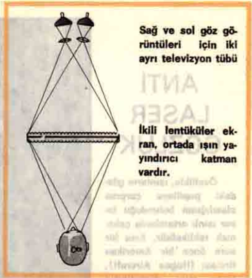
ŞEKİL 5 : Yön-seçici üç boyutlu televizyonun daha iyi bir modeli: Her bir göz için oluşturulan resim, ayrı televizyon tüpleri tarafından izleyiciye yansıtılır.
